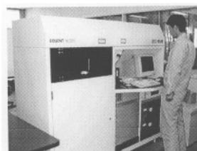
鋼粉末を用いて高強度の RP 造形により金型等に使える物を目指して研究されている。密度 95% の物まで出来るそうです
